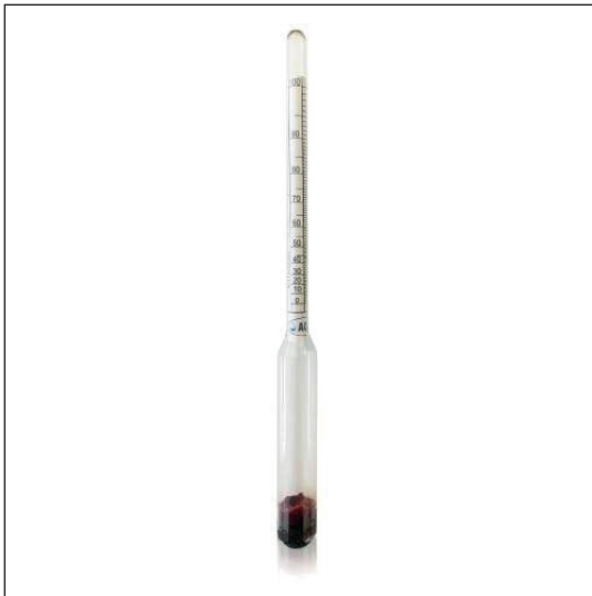
Şekil 1: Alkol konsantrasyonunu ölçmek için laboratuvarımızda bulunması gereken alkolmetre.
